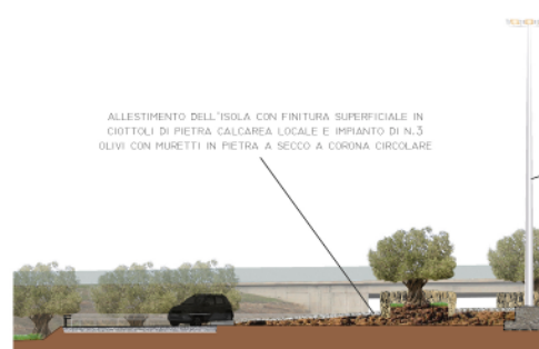
3. SEZIONE TIPO DELLE ROTATORIE CON INDIVIDUAZIONE DEGLI INTERVENTI DI MITI
